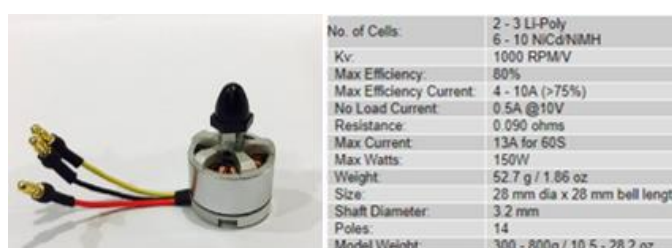
Figura 2.5: Datos técnicos del motor para vehículos aéreos no tripulados tipo brushless [21].
