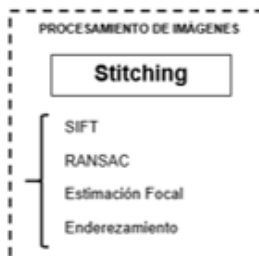
Figura 2.30: Esquema del módulo de procesamiento de imágenes.
