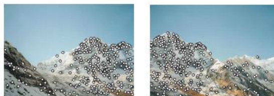
Figura 2.31: Identificación de características en imágenes usando el algoritmo SIFT [40].
