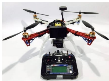
Figura 2.3: Dron ensamblado y adaptado para misiones de reconocimiento y mapeo de superficies.
