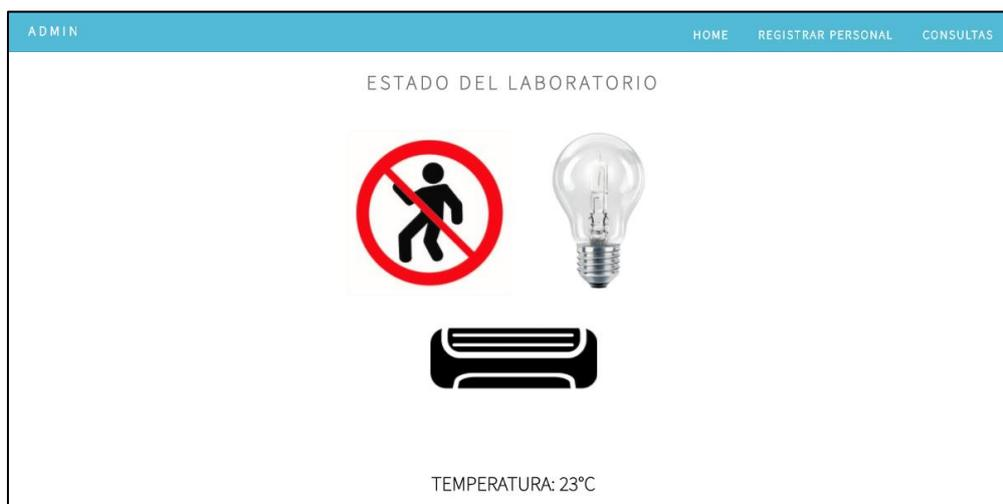
**Figura 3.16: Página principal mostrando el estado del laboratorio, no existe movimiento, la temperatura es 23 °C, las luces y el aire acondicionado están apagados**
