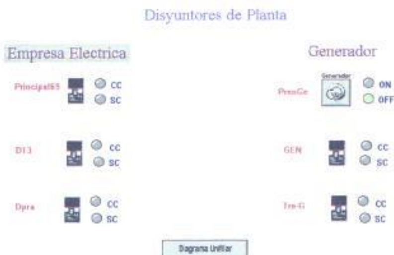
Figura 3.14.- Pantalla para el control de disyuntores del sistema
