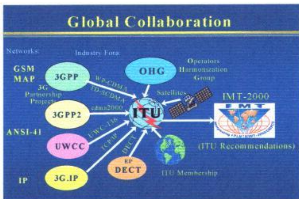
FIGURA 3.7. Organizaciones y Estándares para los sistemas de Tercera Generación reconocidos por la ITU
