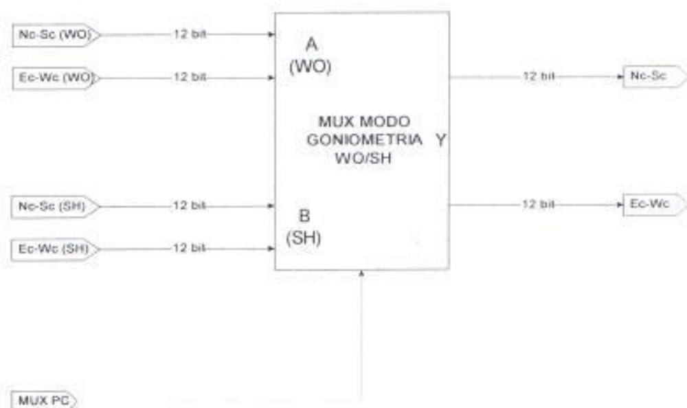
Figura 4.10 MULTIPLEXACION PARA MODO WO Y SH
