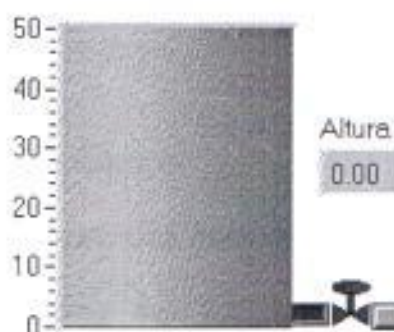
FIGURA 3.20 Tanque que representa el Nivel de Líquido de la Planta Didáctica.
