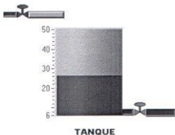
FIGURA 3.24 Nivel de líquido es mayor que el Setpoint, la Válvula de ingreso de agua se encuentra cerrada.
