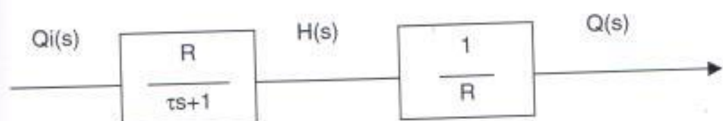
FIGURA 2.5 Diagrama de bloques del Proceso de circuito abierto
