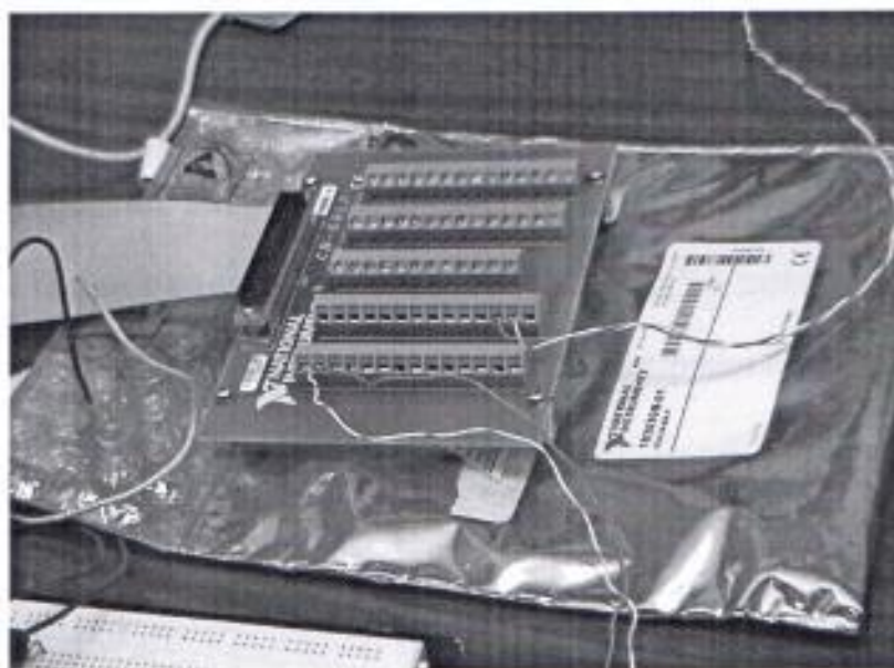
Figura 4.3 Bloque Conector y Cable de conexión para la PCI-6024E
