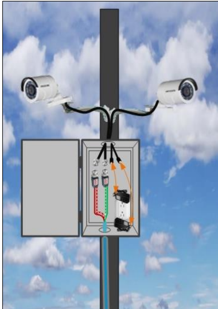
Figura 2.11. Cajetín y soporte de cámaras.
