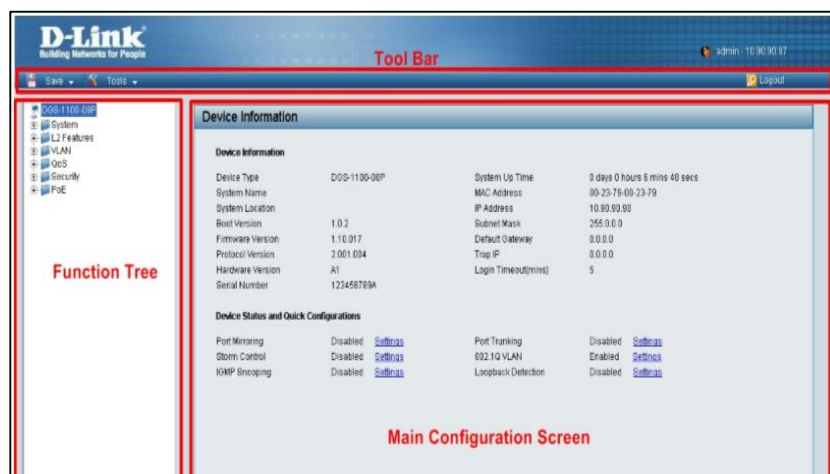
Figura 2.24. Panel principal de administración switch.
