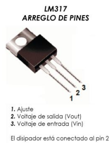
Figura 2.4.7: Regulador de voltaje LM317 [15]
