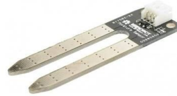
Figura 2.4.4: Sensor de Humedad SEN0114 [9]
