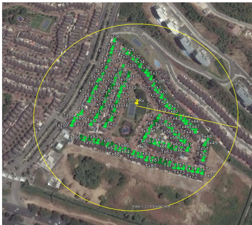
Figura 3.9: Ubicación de cada sensor con su nodo
