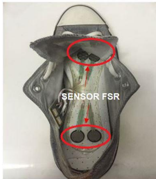
Figura 3.9 Ubicación de los Sensores de Fuerza
