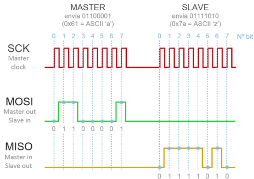
Figura 3.11 Funcionamiento de la Comunicación SPI.
