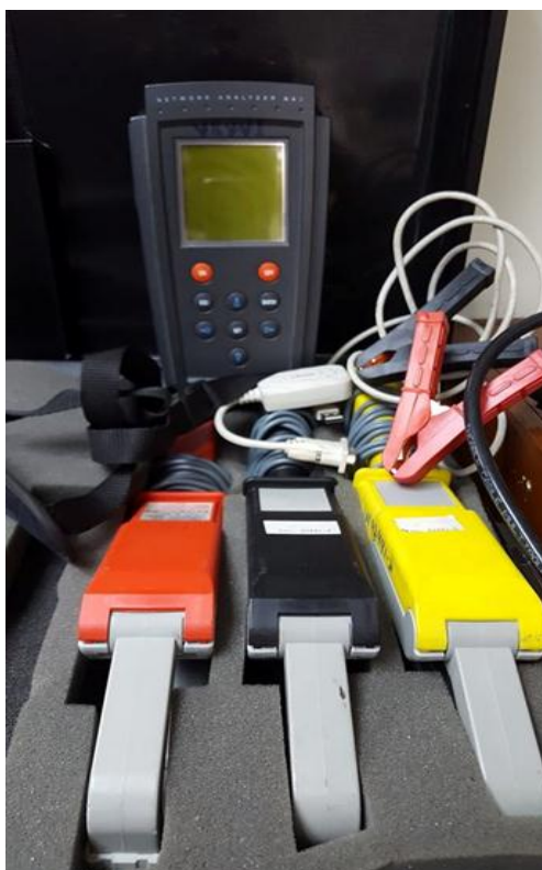
Figura 3.1 Analizador de redes CIRCUTOR
