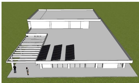
Figura 3.15 Montaje de los paneles fotovoltaicos sobre el CIDIS
