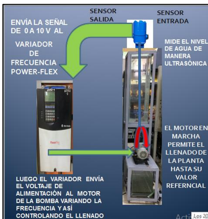
Figura 4. 3. Diseño de control de planta de agua
