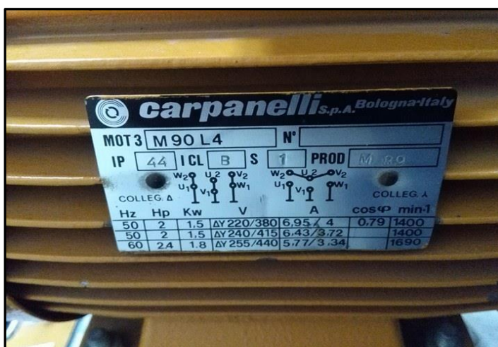
Figura 3. 12 Placa del motor
