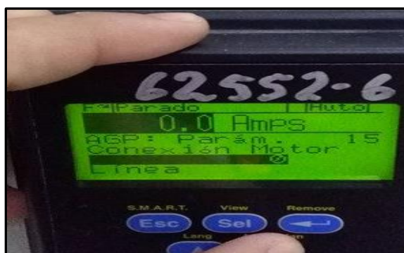
Figura 3. 24. HMI Conexión línea
