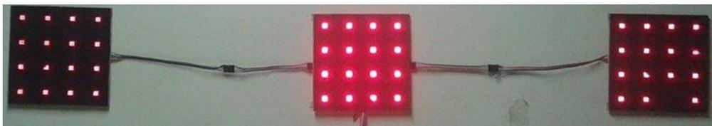
Figura 4.2. Matriz led con atenuación en el primer y tercer bloque de leds
