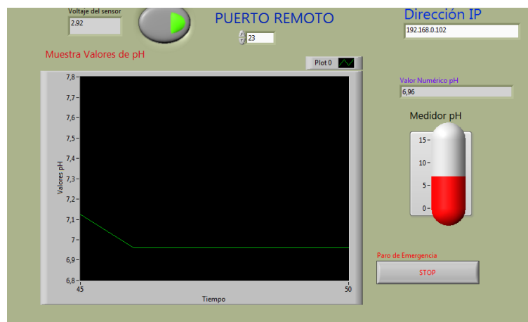
Figura 4.5: Medición inalámbrica de pH.
