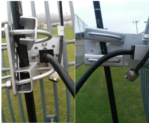
Figura 3.15 – Antenas sujetas al trípode
