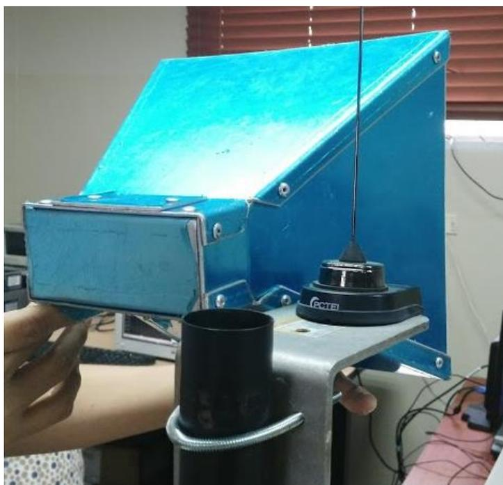
Figura 4.15 – Imagen de la antena Horn
