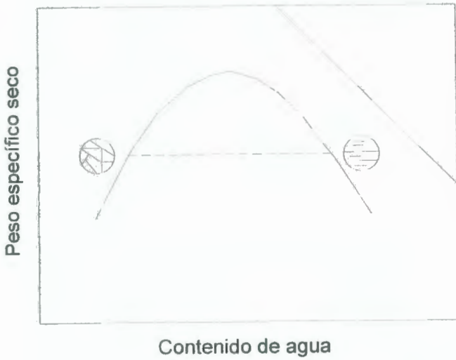
COMPACTACIÓN POR AMASADO
