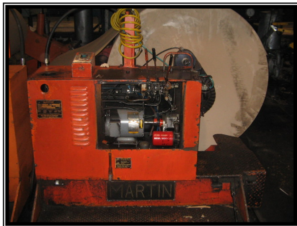
FIGURA 1.2. Elevador de bobina accionado por un motor AC Jaula de Ardilla.
