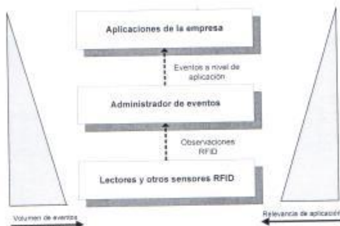
Figura 2.13 Volumen y relevancia de eventos a través de las capacidades de un sistema RFID
