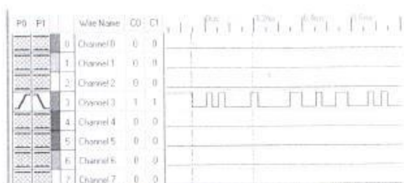
Figura 4.4 Byte de la trama generada en la salida SOUT.
