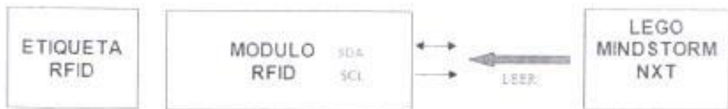
Figura 3.14 Sistema de comunicación NXT-módulo lector RFID comando "LEER"
