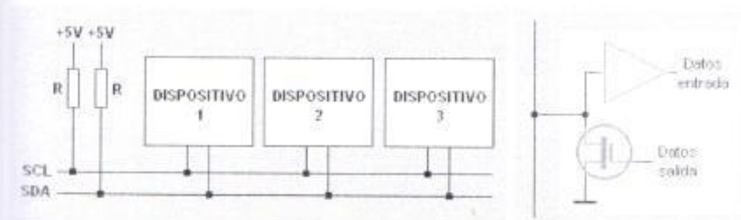
Figura 3.18 Diagrama del bus I2C
