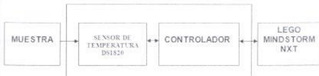
Figura 3.29 Diagrama de bloques del módulo sensor de temperatura
