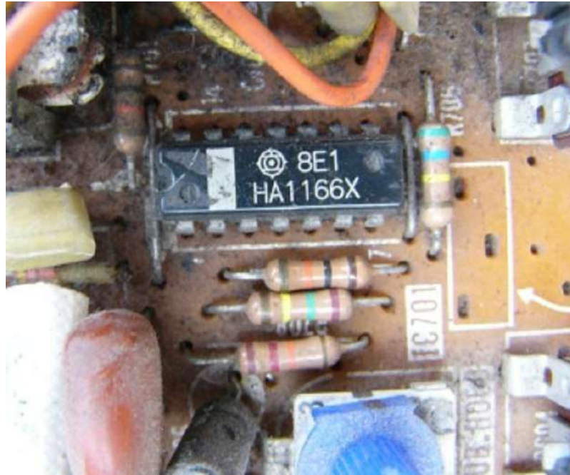
Fig.3.4.Circuito integrado responsable del barrido vertical del monitor.
