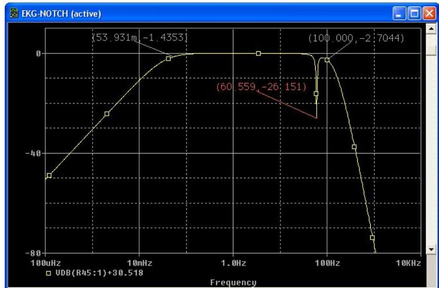
FIGURA 3.18 DISEÑO BW EKG Y FILTRO NOTCH DE
