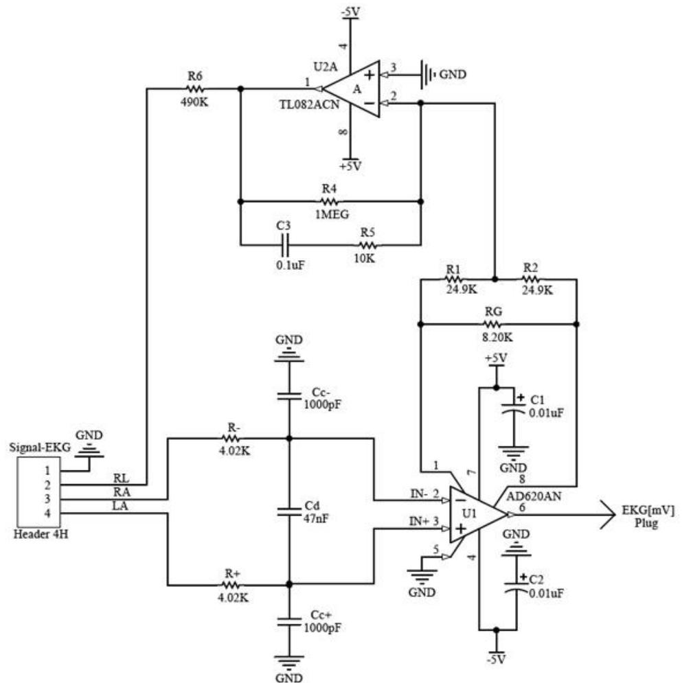
FIGURA 3.2 CIRCUITO DE INSTRUMENTACIÓN PARA UN EKG
