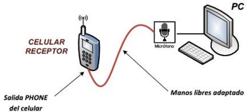
FIGURA 4.6 CONEXIÓN CELULAR-COMPUTADORA EN EL UMTSB
