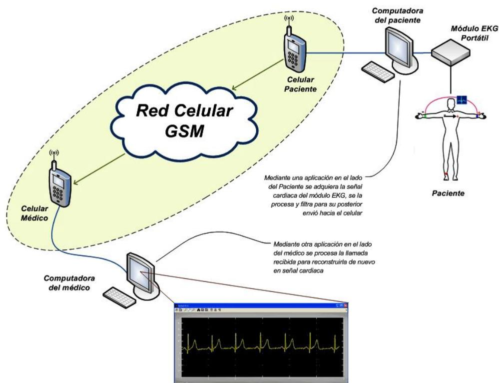
FIGURA 2.1 MODELO GENERAL DEL SISTEMA DE TRANSMISIÓN
