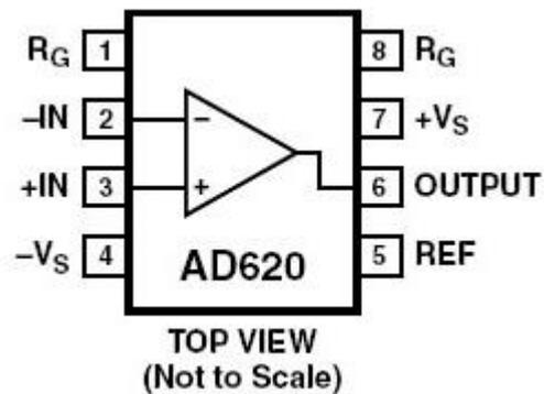
FIGURA 3.1 CONFIGURACIÓN DE LOS PINES
