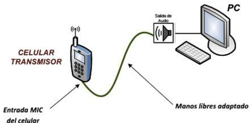
FIGURA 3.25 CONEXIÓN CELULAR-COMPUTADOR
