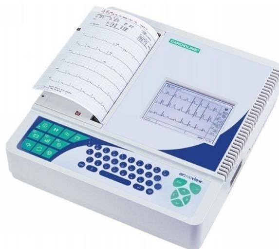
FIGURA 1.14 ELECTROCARDIÓGRAFO DIGITAL DE DOCE DERIVACIONES
