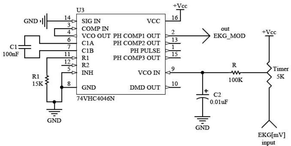
FIGURA 3.13 CIRCUITO MODULADOR FM PARA SEÑALES EKG
