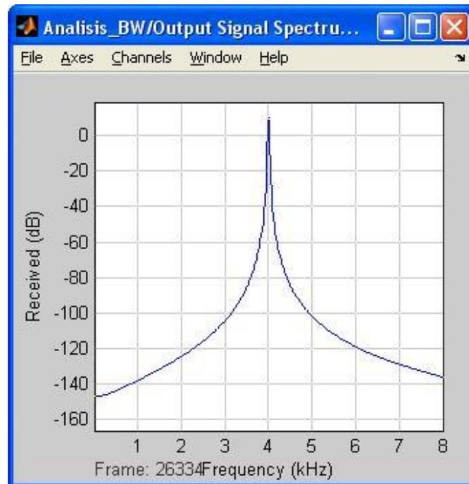
FIGURA 2.8.19 SEÑAL SINUSOIDAL TRANSMITIDA A
