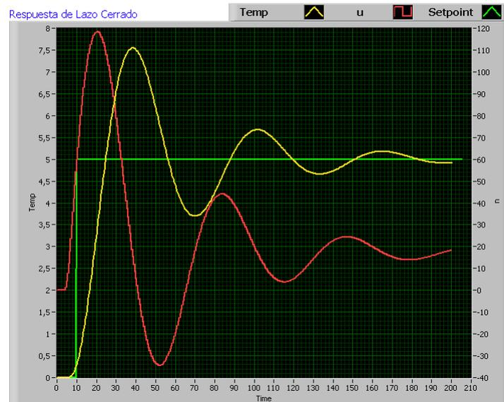
Fig. 4.13.a: Respuesta simulación horizontes: de predicción=10 - de control=4
