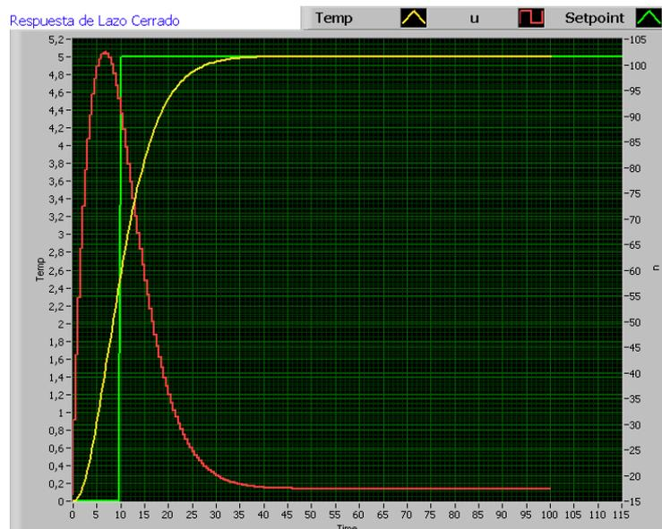
Fig. 4.13.b: Respuesta simulación horizontes: de predicción=30 - de control=4
