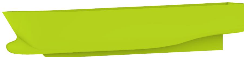
Figura 4.2: Modelo 3D del catamarán con bulbo.
