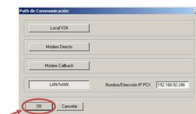
Figura 3.12 Dirección IP de la CPU para acceder
