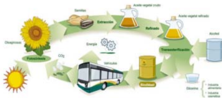
FIG 2.3 CICLO DEL BODIESEL
