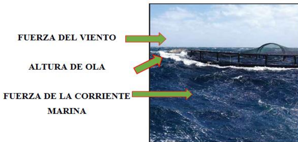
Figura 18.-Representación gráfica de las fuerzas a las que son sometidas las jaulas marinas.
