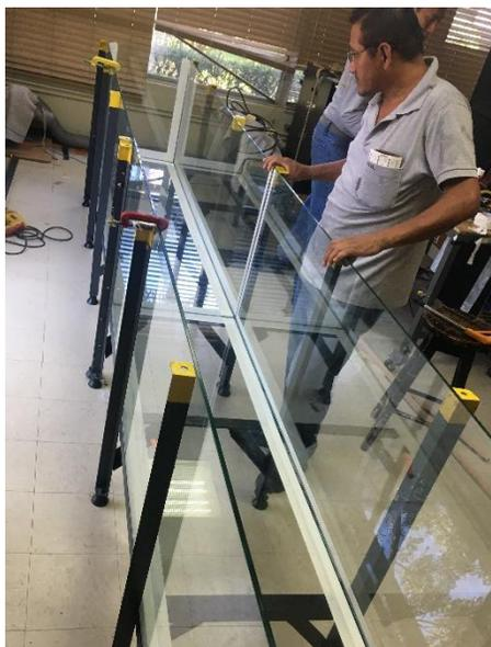
**Figura 2.8 Tanque de vidrio templado**
