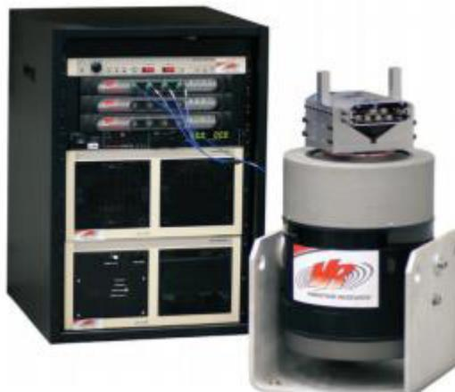
**Figura 1.7 Vibrador VR5800-BSR y amplificador de potencia**
