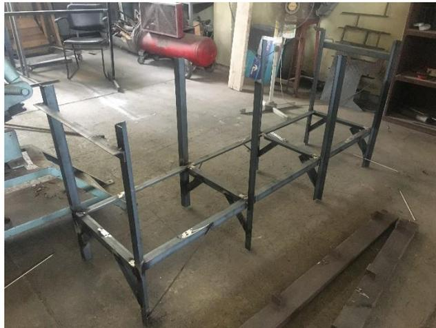
**Figura 2.7 Base del tanque**
