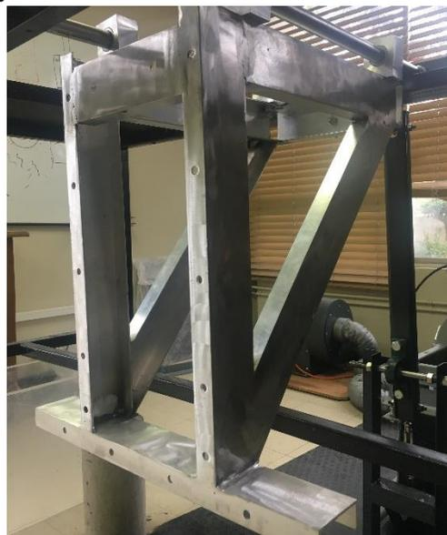
**Figura 2.3 Ensamble del generador de olas**
