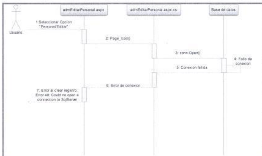
Figura 2-24: Eliminación Fallida de un Recurso Humano por Falla con la conexión a la BD
