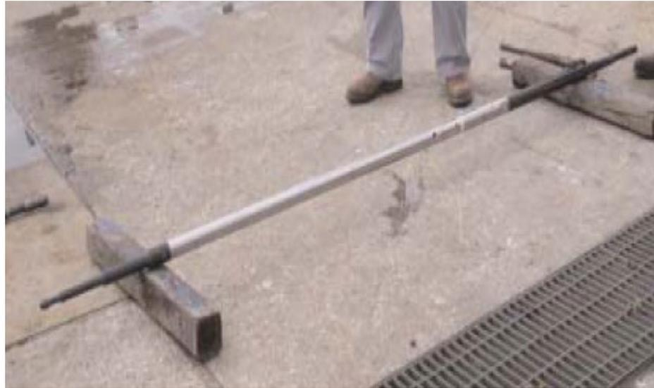
FIGURA 2.4. BARRA DETONADORA O DROP BAR
