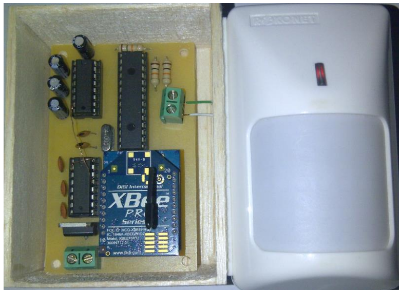
Figura 3-4 Dispositivo electrónico del Bloque Emisor
