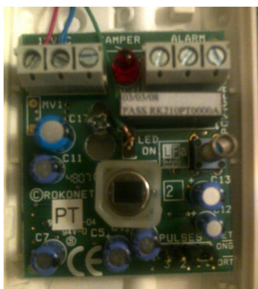
Figura 3-2 Circuito del Sensor de Movimiento
