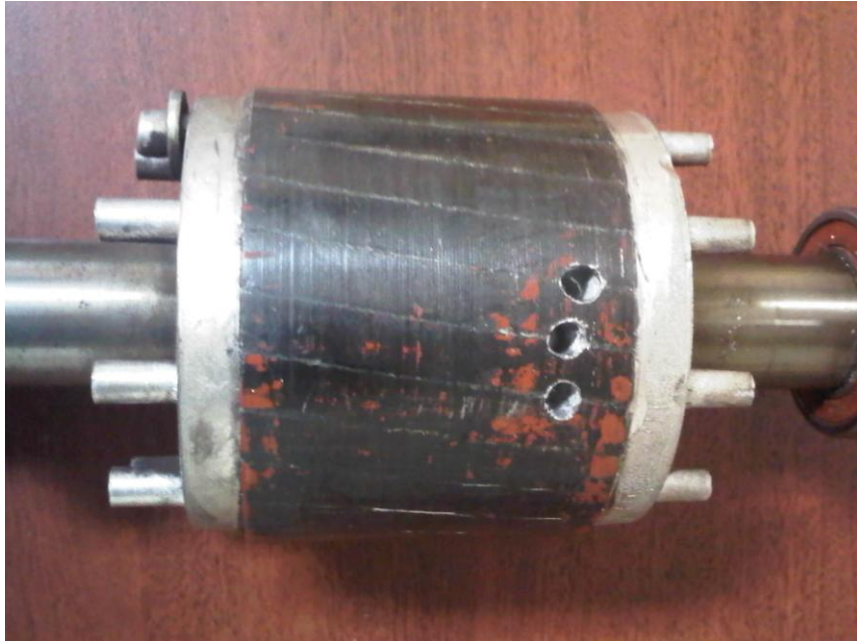
Figura 4.22 Rotura de 3 barras en el rotor
