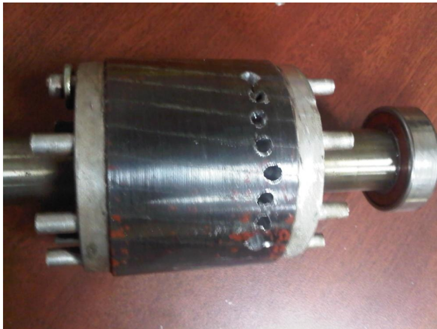
Figura 4.57 Rotura de 8 barras en el rotor
