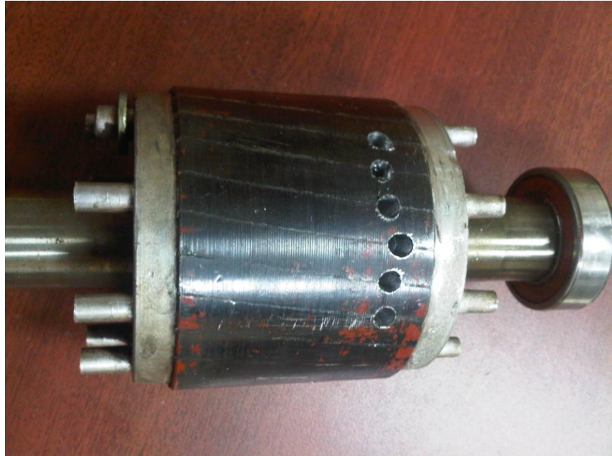
Figura 4.43 Rotura de 6 barras en el rotor
