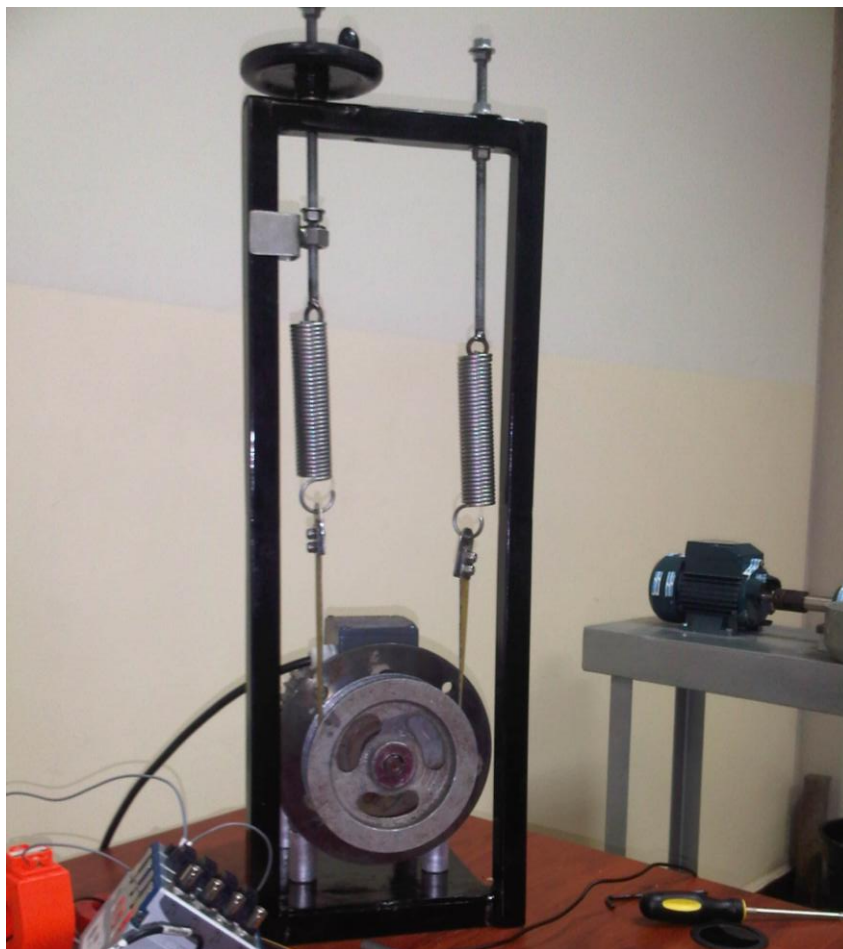
Figura 3.5 Mecanismo utilizado en la prueba para regular la carga en el eje del rotor
