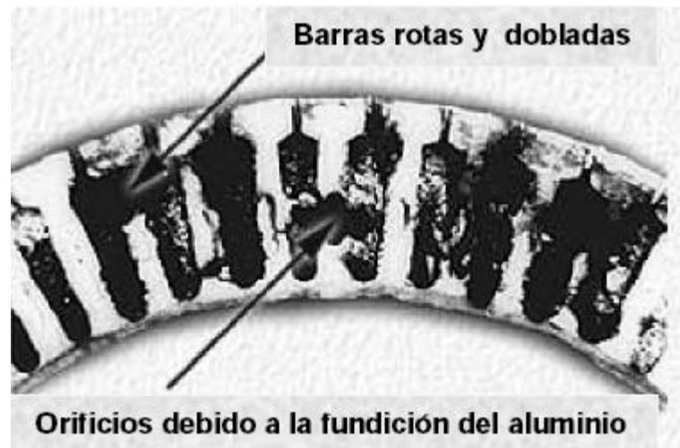
Figura 2.5 Anillos de unión con barras rotas
