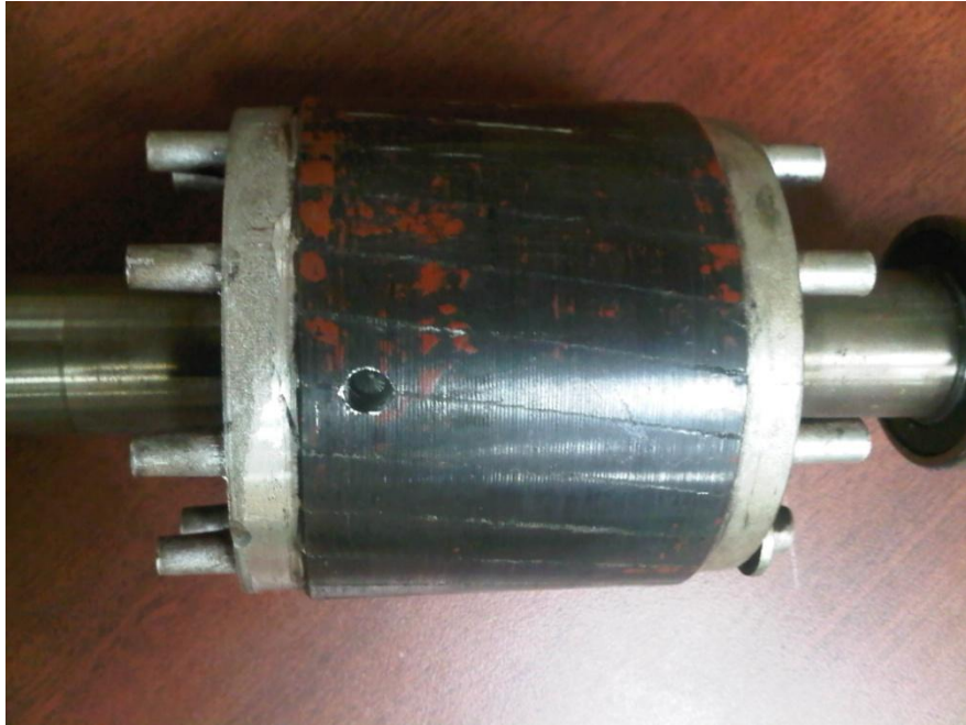
Figura 4.8 Rotura de una barra en el rotor
