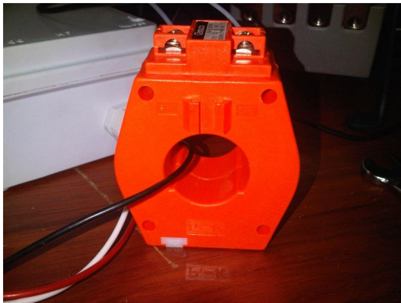
Figura 3.4 Transformador de corriente utilizado en las pruebas
