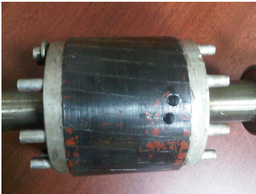
Figura 4.15 Rotura de 2 barras en el rotor
