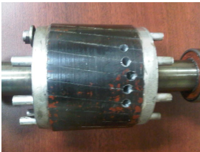
Figura 4.36 Rotura de 5 barras en el rotor
