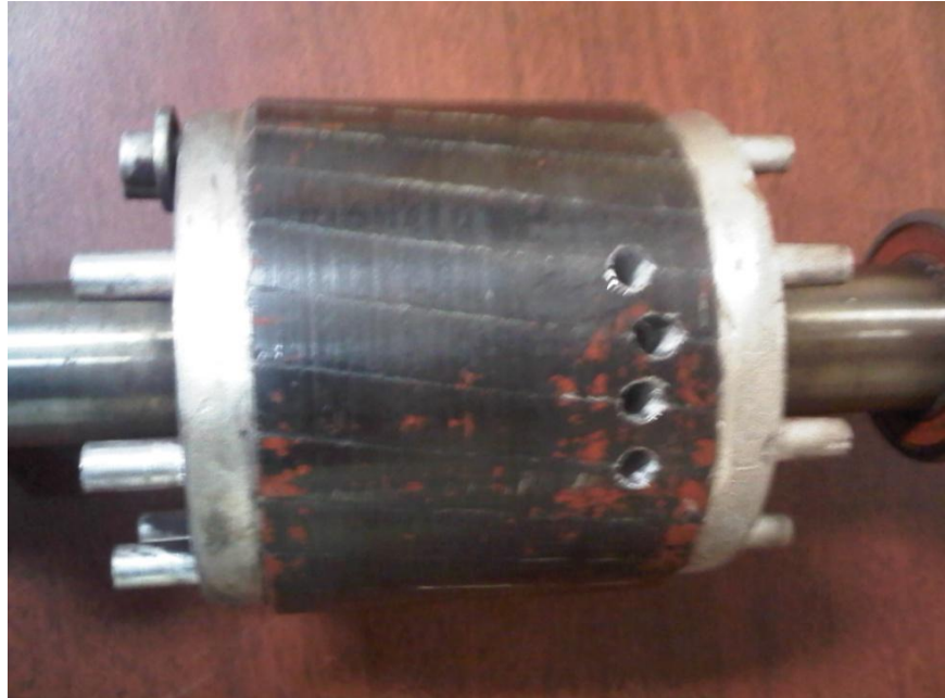
Figura 4.29 Rotura de 4 barras en el rotor
