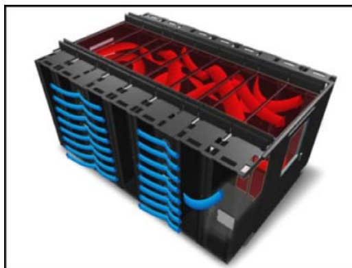
Figura 2.12 Contención de pasillos calientes
