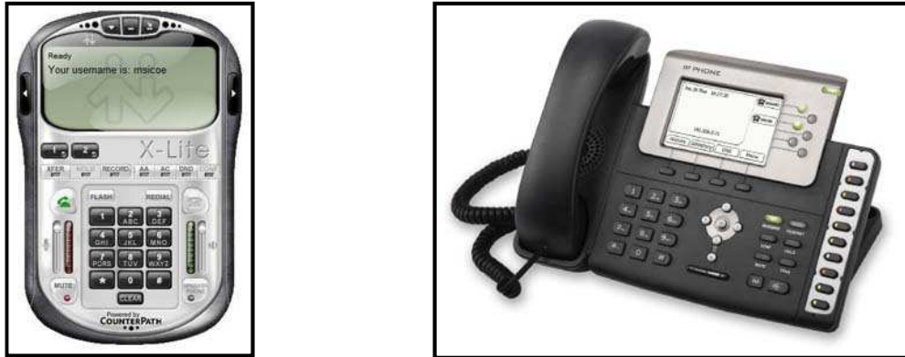
Figura 2-3.- Lado izquierdo Softphone X-lite, lado derecho teléfono IP.
