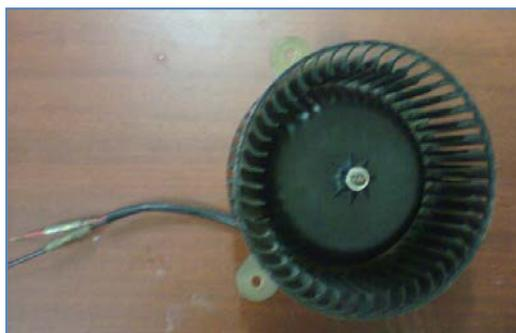
**Figura 3.19:** Ventilador centrífugo utilizado en automóviles.
