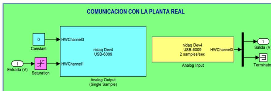
Figura 3.30: Entorno gráfico del subsistema "Planta Real".
