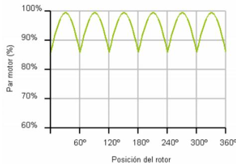
**Figura 2.15 Rizado del par motor**
