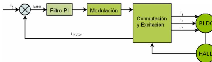
**Figura 2.13 Esquema de un controlador con conmutación trapezoidal**
