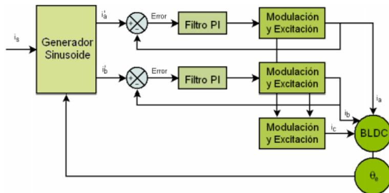
**Figura 2.16 Esquema de un controlador con conmutación sinusoidal**
