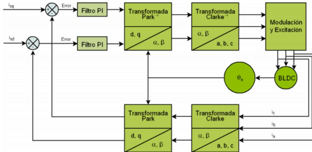
**Figura 2.18 Esquema de controlador con control vectorial**
