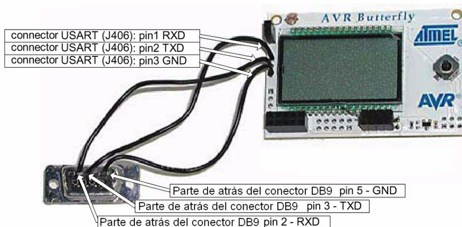
**Figura 2.8 Conexiones para interfaz USART del AVR Butterfly [4]**
