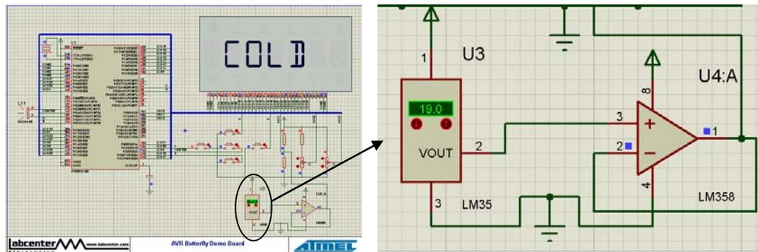
**Figura 4.5 Temperatura baja mostrada en AVR Butterfly**
