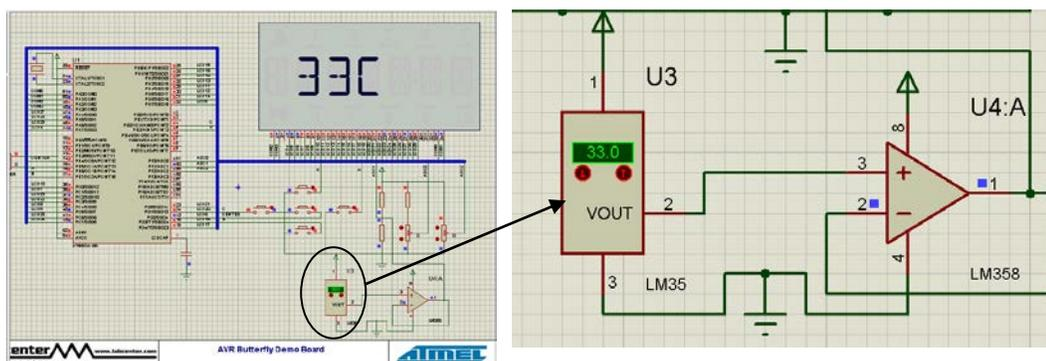
**Figura 4.3 Temperatura normal mostrada en AVR Butterfly**
