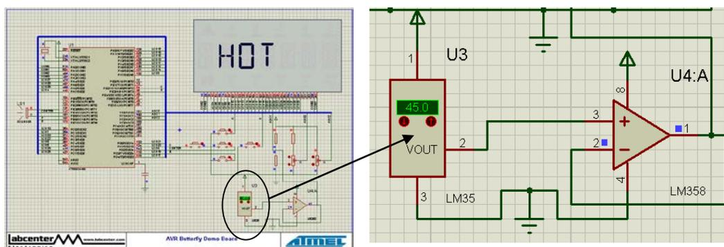
**Figura 4.4 Temperatura alta mostrada en AVR Butterfly**
