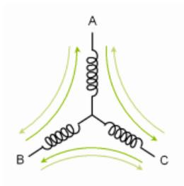
**Figura 2.12 Esquema caminos de circulación de corriente**
