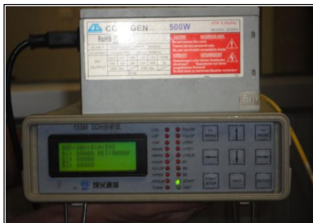
Figura 4.34.- Equipo de Comprobación para la transmisión de señales E1 [9]
