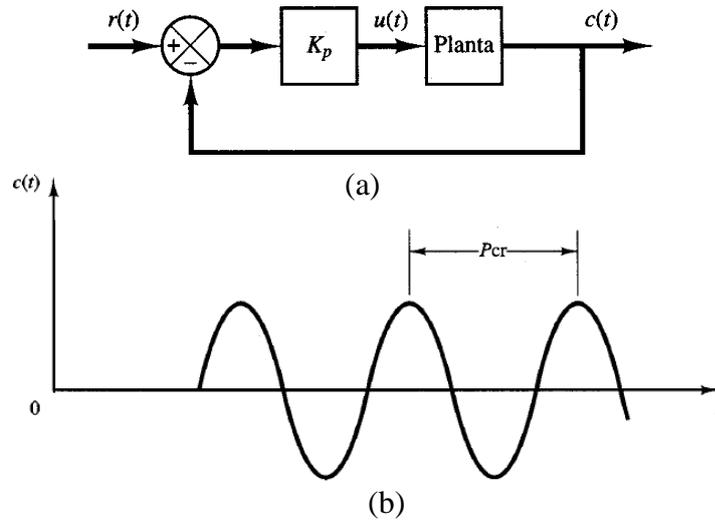
Figura 3.13: Sistema en lazo cerrado con control proporcional
