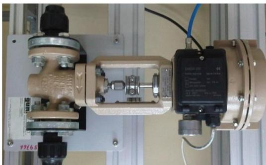
*Figura 1.7: Válvula de accionamiento neumático SAMSON 3760*
