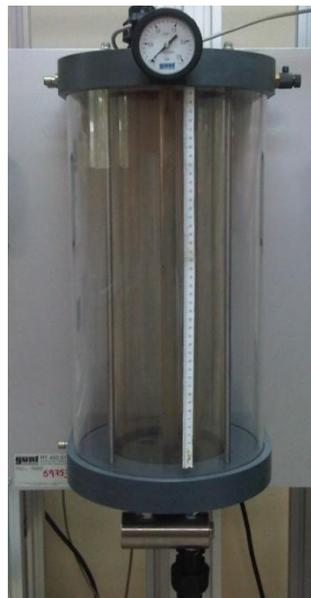
*Figura 1.3: Módulo controlador de nivel RT 450.01*
