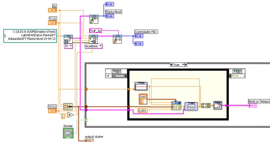
Figura 3.12: LabVIEW: Diagrama de Bloques Simulación Planta
