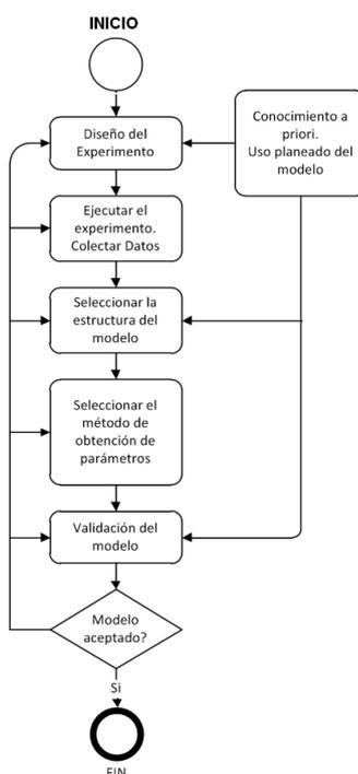
Figura 3.21: Diagrama de flujo de la identificación de sistemas <sup>(17)</sup>
