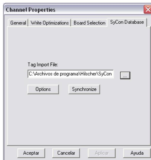
*Figura 2.32: NI OPC Server: Sincronizar con SyCon Database*
