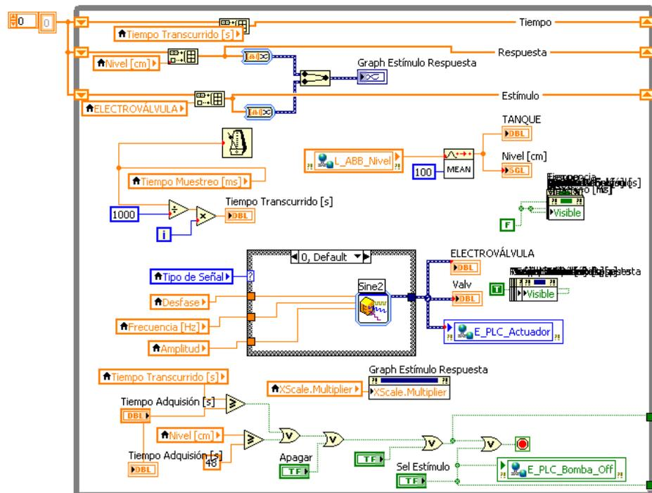
Figura 3.3: LabVIEW: Diagrama de bloques VI “Adquisición de Datos”
