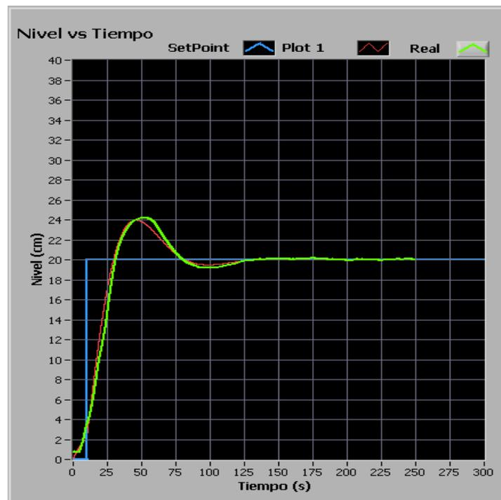
Figura 3.29: Curva de respuesta planta con controlador PID (1)
