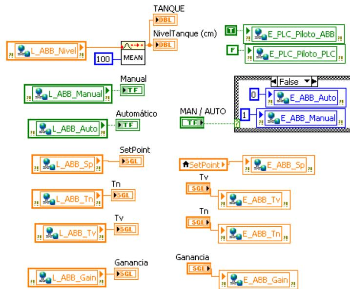
Figura 3.20: LabVIEW: Diagrama Bloques panel control desde ABB
