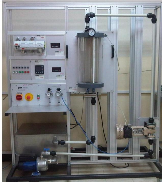
*Figura 1.2: Planta de Regulación de Nivel*
