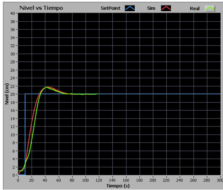
Figura 3.30: Curva de respuesta planta con controlador PID (2)
