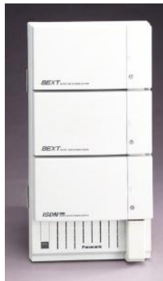
Figura F.1 Central analógica fabricante Panasonic modelo KD-TX1232 con 24 llamadas externas
