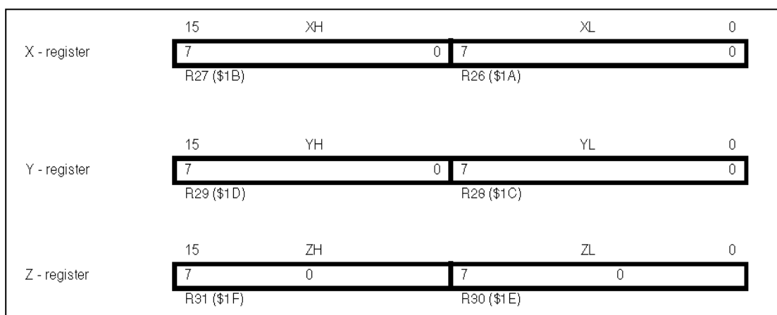
Figura 2.10 AVR-CPU Registros X, Y y Z.
