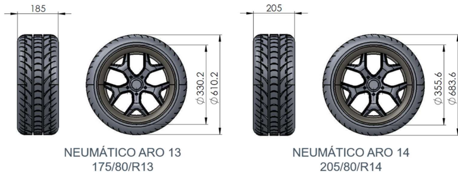
Figura 2.2 Dimensiones de neumáticos R13-R14.
