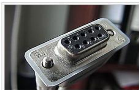
Figura 2.12. Conector RS-232, DE-9 hembra (Ref.[7])
