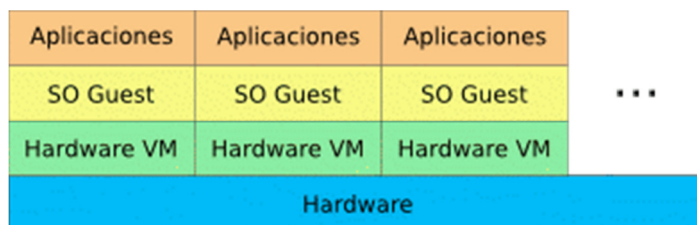
Fig. 2.4 Virtualización a nivel de hardware.
