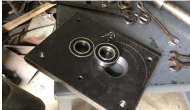
**Figura 3-7 Rodamientos y la placa de 15 mm de la caja de trituración.**
