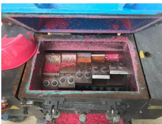
**Figura 1-6 Trituradora de cuchillas de un eje.**
