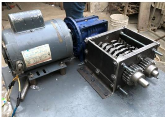
**Figura 3-10 Ensamble de la parte mecánica de la máquina trituradora.**
