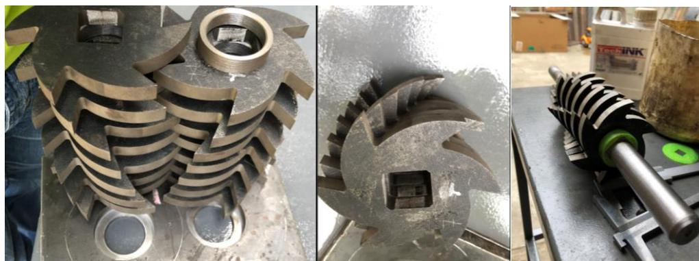
**Figura 3-8 Orden de cuchillas en el eje de la trituradora.**
