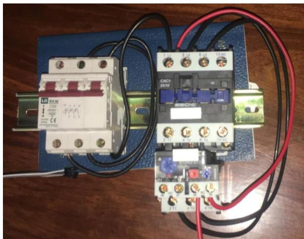
**Figura 3-11 Elementos del circuito de potencia conectados.**
