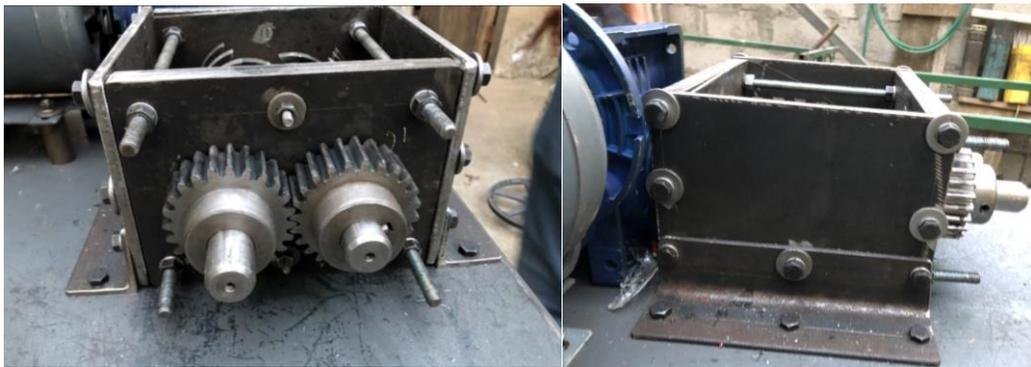
**Figura 3-9 Engranés de la caja trituradora y ángulos en la caja de trituración.**
