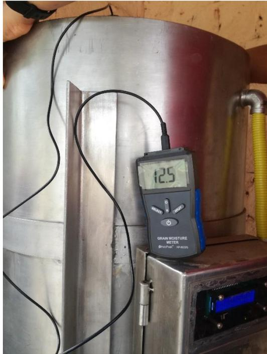
**Figura D15. Medición de humedad de grano con un equipo digital [Xavier Mantilla, 2018]**
