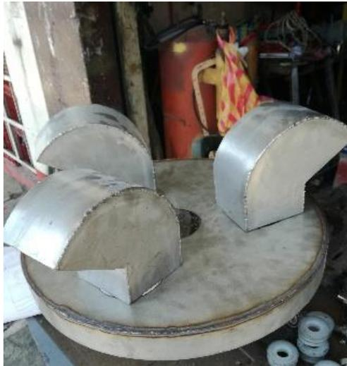
Figura D1. Tapa de tanque contenedor con respiraderos instalado [Xavier Mantilla, 2018]
