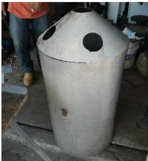
Figura D2. Tanque contenedor junto con base cónica y agujeros [Xavier Mantilla, 2018]
