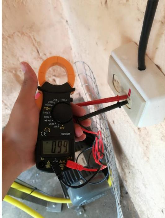
Figura D13. Prueba de funcionamiento, medición de voltaje [Xavier Mantilla, 2018]
