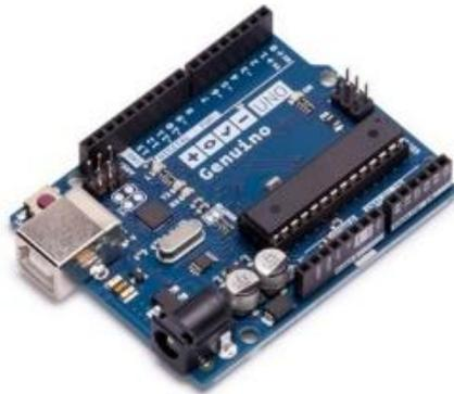
Figura A1. Foto de microcontrolador Arduino [Arduino, 2018]
