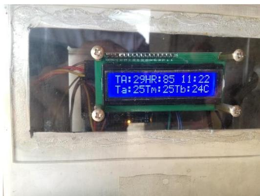
**Figura D10. Pantalla Lcd muestra datos ambientales y temperatura de grano [Xavier Mantilla, 2018]**
