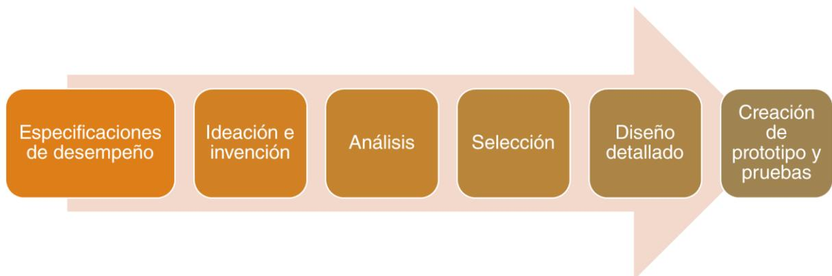
**Figura 2.1. Proceso de diseño [Norton, R., 2009]**
