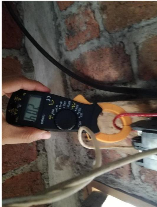
Figura D14. Prueba de funcionamiento, medición de corriente [Xavier Mantilla, 2018]
