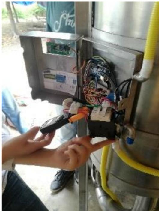
Figura D12. Prueba de funcionamiento, medición de flujo de corriente [Xavier Mantilla, 2018]
