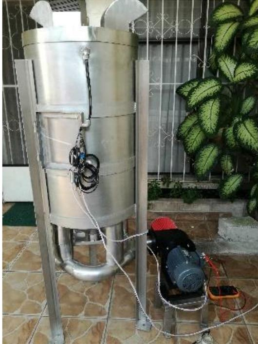
**Figura D6. Unión de ventilador junto con su integración con el control [Xavier Mantilla, 2018]**
