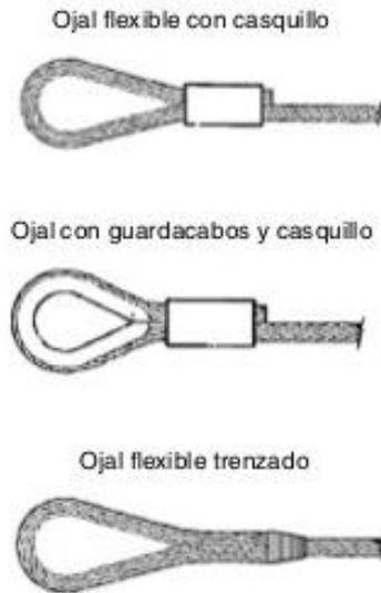
**Figura 2.17 Terminales para los cables de acero**
