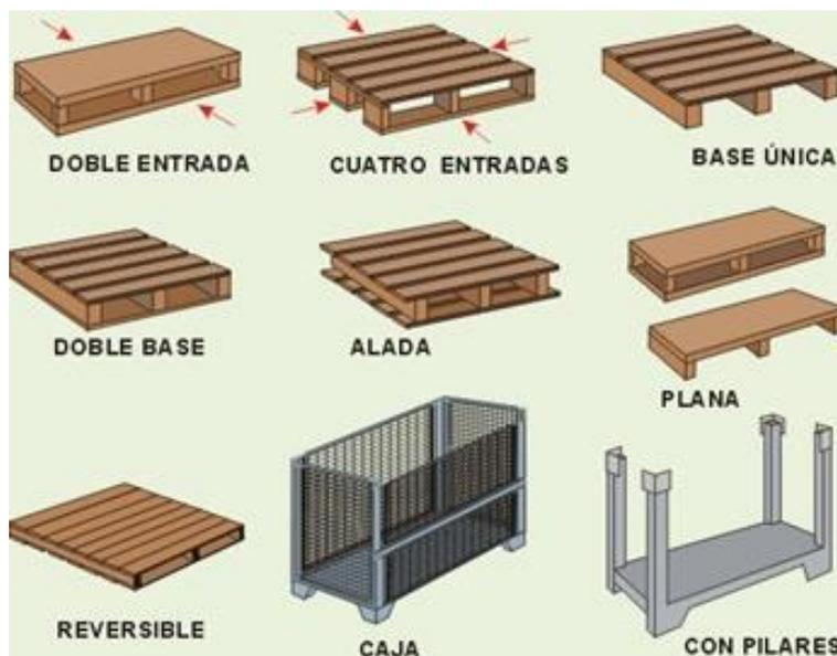
**Figura 1.1 Tipos de Pallet según su fabricación**
