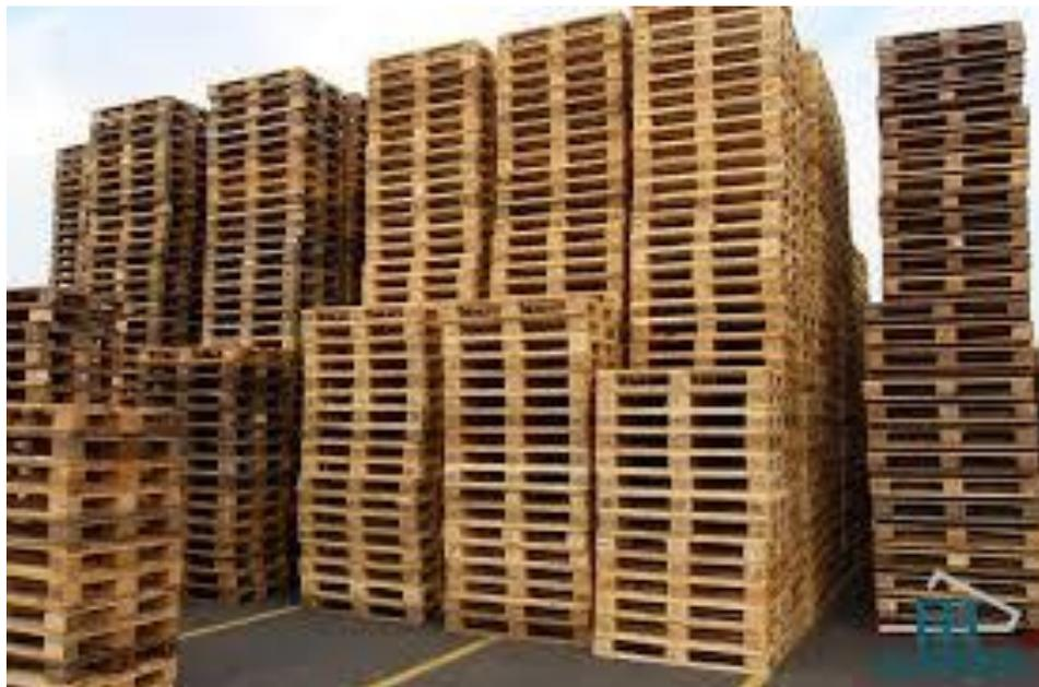
**Figura 1.10 Apilado de pallets, secado por convección natural**
