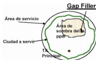
**FIGURA 4.13 UTILIZACIÓN DE GAP FILLER**
