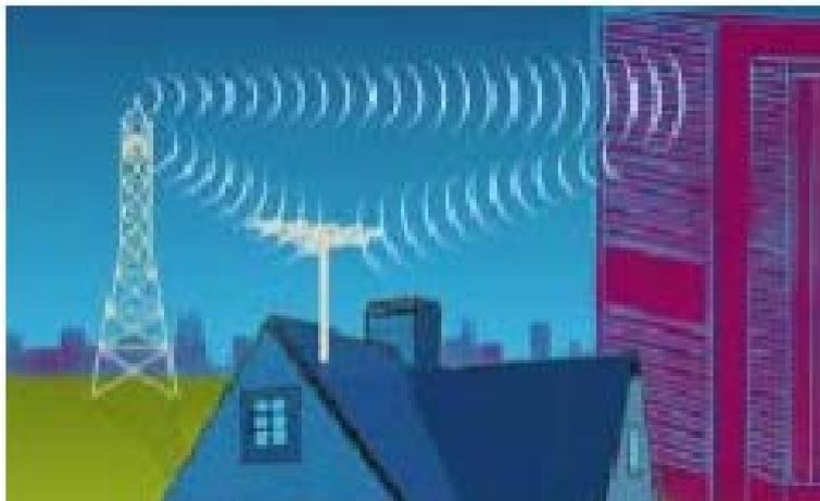
**FIGURA 2.11 INTERFERENCIA POR MULTITRAYECTO**
