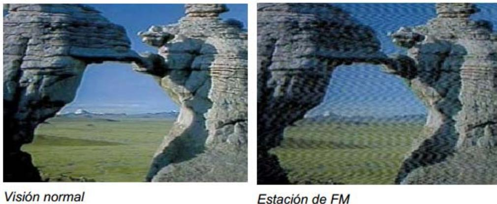
**FIGURA 2.15 EJEMPLO DE INTERFERENCIA POR ESTACIÓN FM**
