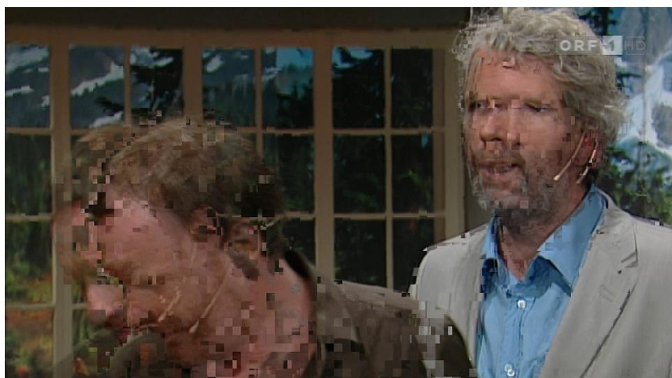
**FIGURA 4.16 EJEMPLO DE PIXELACIÓN DE UNA SEÑAL**
