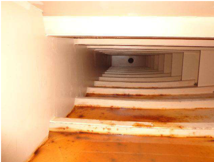
Ilustración 34. Vista de doble fondo de barcaza tanque. (Fuente: Víctor Suárez Holguín).
