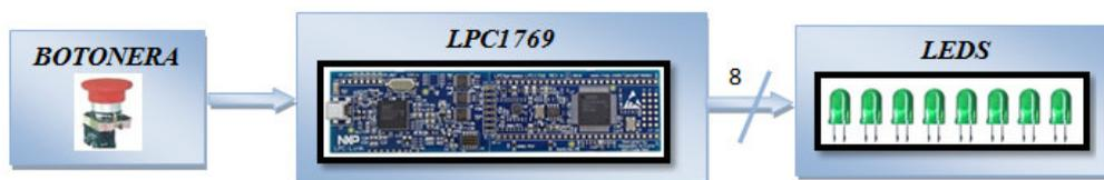
Figura 3.3.: Bloques de Secuencia de Leds.
