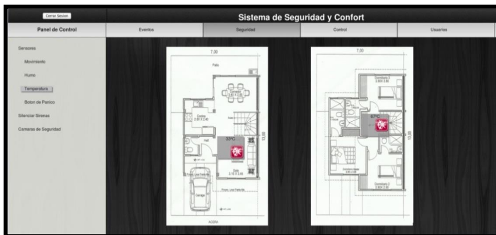
Figura 4.5b. Ubicación de los Sensores de Temperatura.
