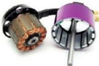
Figura 2.5: Motor sin escobilla (BLDC).
